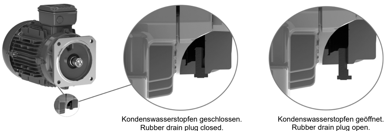
Bild 21: Detail des Kondenswasserstopfens am Lagerschild.
